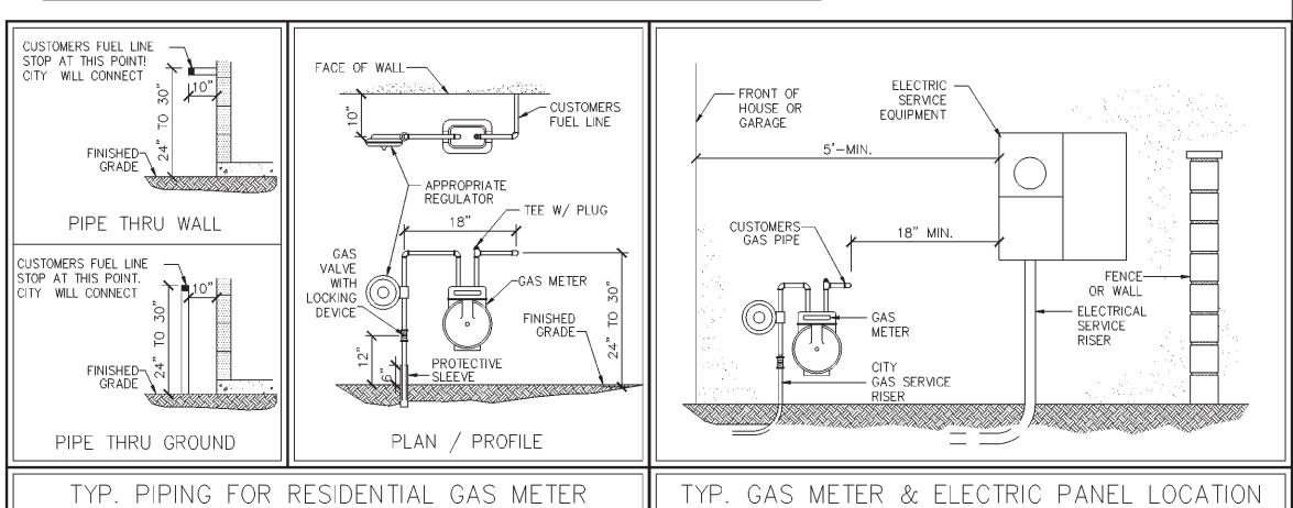
TYP. GAS METER & ELECTRIC PANEL LOCATION
